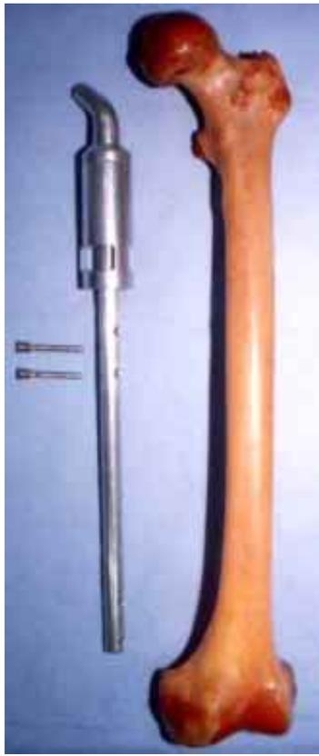
**Figura 3.** Fémur fresco de cadáver y el prototipo de la PNC y los pernos empleados.
